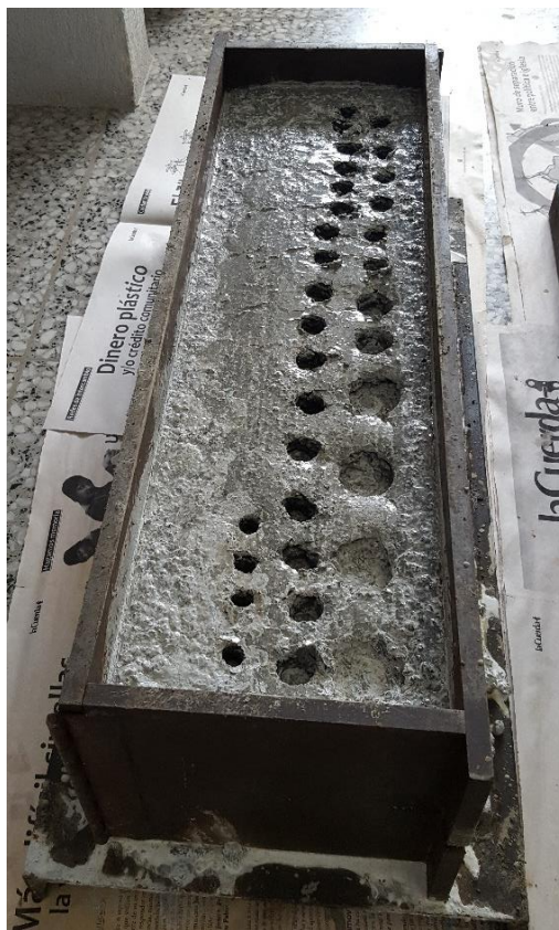
Figura 23. Espécimen ensayado durante 18 horas
