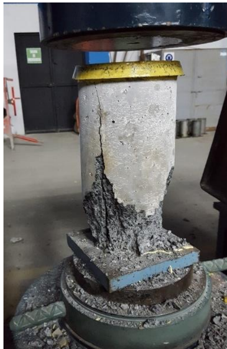
Figura 24. Ensayo a compresión
