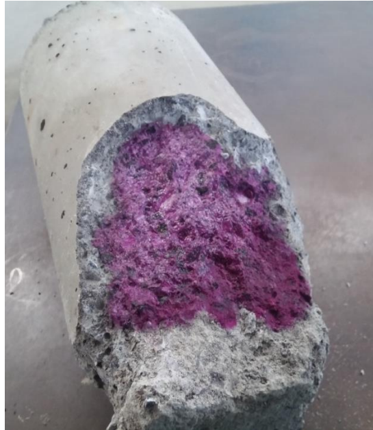
Figura 25. Ensayo de carbonatación
