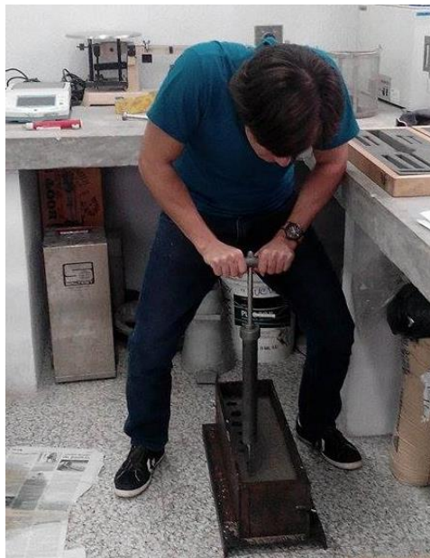
Figura 22. Toma de lectura de la resistencia a la penetración
