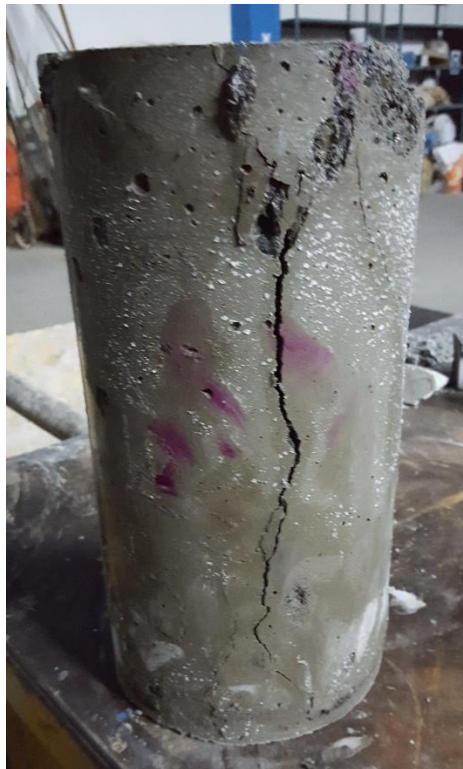
Figura 27. Grietas en cilindro con 0,15 % de azúcar morena
