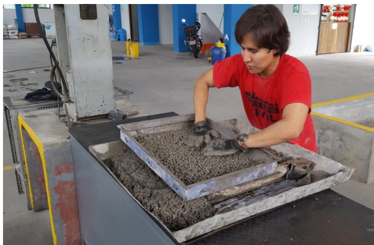
Figura 21. Tamizado en húmedo del concreto
