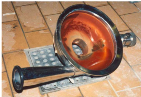
Figura 6. Carcasa de bomba sanitaria SS AISI 316L con rouge
