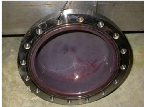
Figura 9. Rouge en tapa inferior de un generador de vapor puro en SS AISI 316L operado a 120 °C
