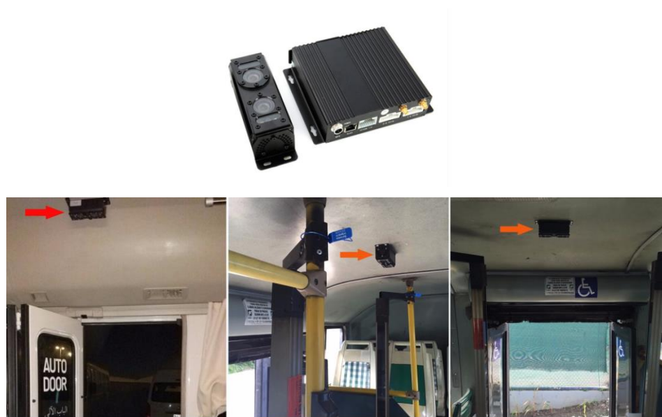
Figura 7. Sensor de Infrarrojo para conteo de pasajeros
