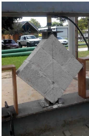
Figura 6. Falla por corte, ensayo a corte en prismas
