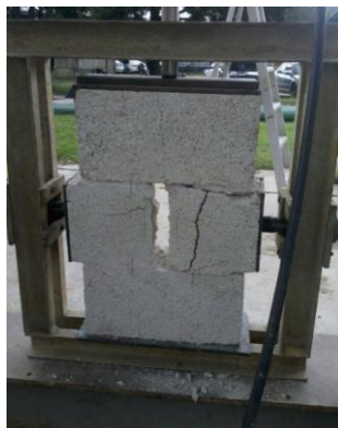
Figura 9. Falla por tracción diagonal, ensayo de adherencia
