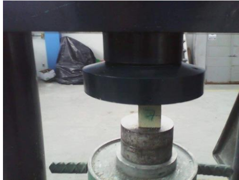
Figura 17. Ensayo a compresión de cubos de mortero
