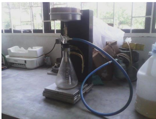
Figura 14. Equipo de retención de agua para morteros
