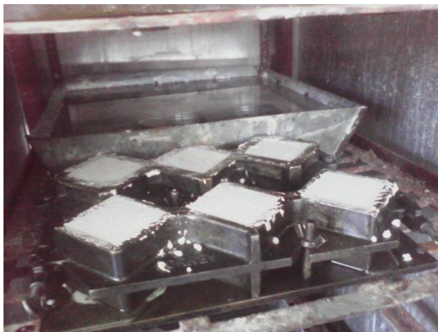
Figura 16. Cubos de mortero hechos con feldespatos estándar
