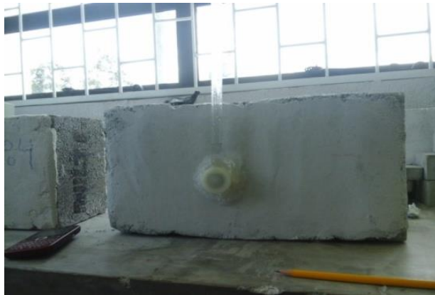
Figura 21. Ensayo de permeabilidad
