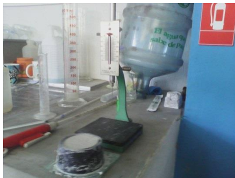
Figura 15. Tiempo de fraguado por medio de la aguja de Vicat
