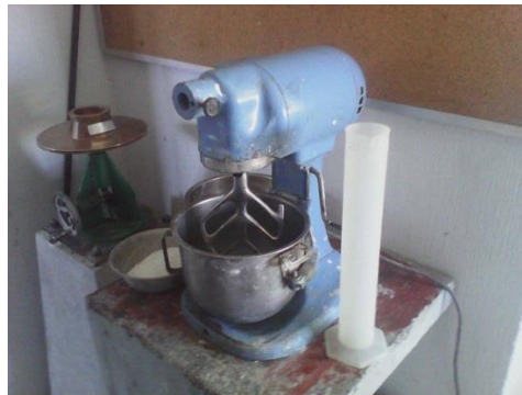
Figura 12. Equipo utilizado en la mezcla de mortero
