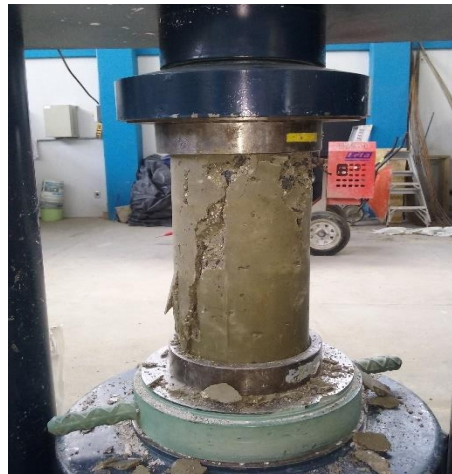
Figura 16. Ensayo a compresión en máquina universal
