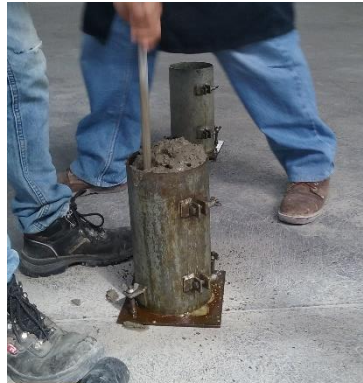
Figura 15. Llenado de cilindros para ensayo a compresión del concreto
