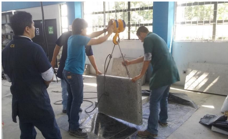
Figura 35. Manipulación de paneles con puente grúa y polipasto
