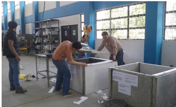
Figura 38. Colocación de cubierta para prueba de sonido
