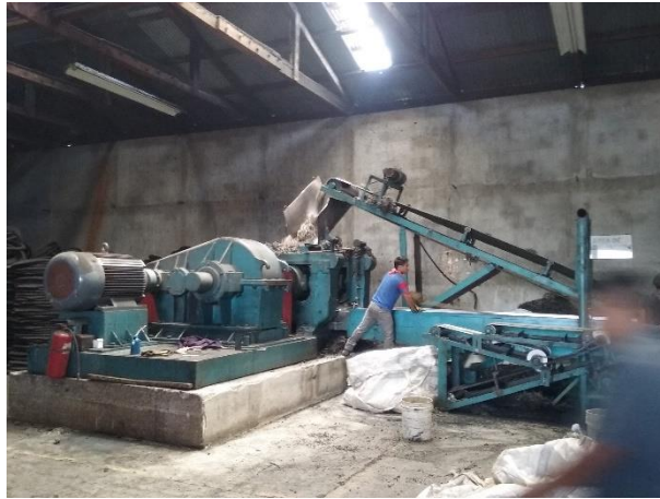
Figura 22. Primer proceso de trituración del neumático
