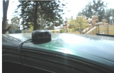
Figura 24. Antena externa para recepción de señal GPS
