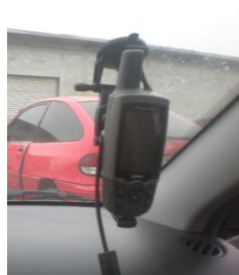
Figura 25. Antena externa y receptor GPS de interfaz gráfica
