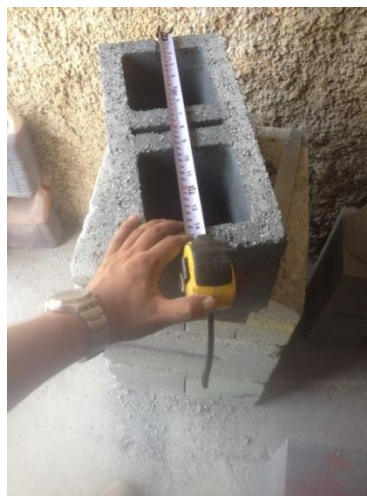
Figura 19. Toma de pesos y dimensiones de los bloques
