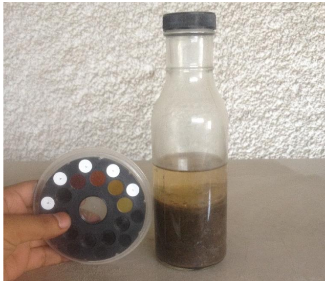
Figura 10. Ensayo para la determinación de materia orgánica en los agregados finos ASTM C-40
