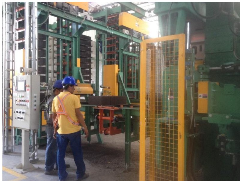
Figura 12. Planta de producción de bloques de concreto
