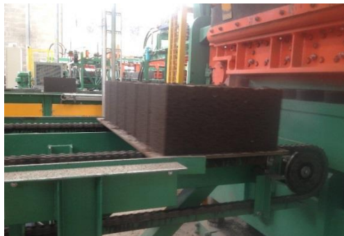
Figura 15. Vibro-compactación del material en los moldes
