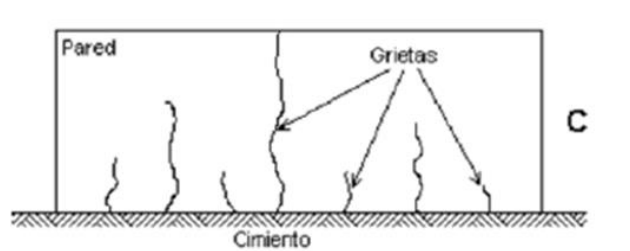
Figura 6. Grietas debidas a restricciones continuas externas
