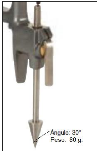
Figura 7. Cono de penetración, en el ensayo de Penetrómetro de cono
