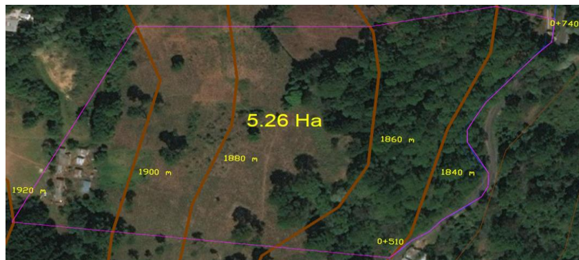
Figura 10. Área tributaria para drenaje transversal
