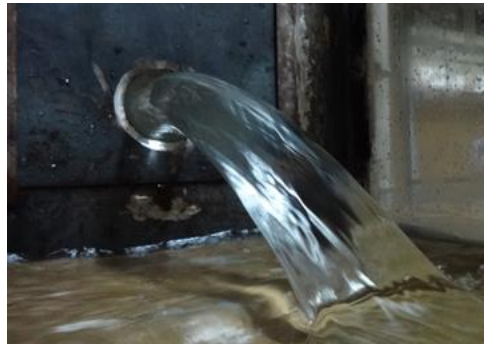
Figura 24. Descarga libre por orificio
