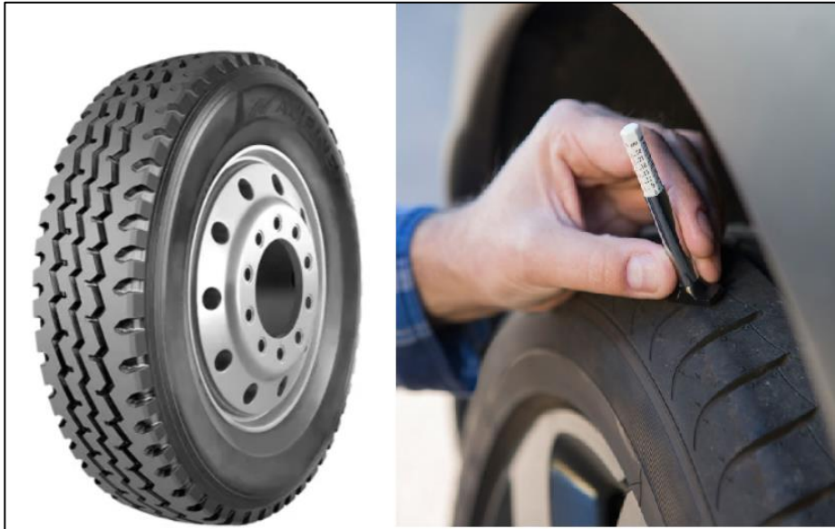
Figura 3. Tipo de llanta a requerir y forma de medir la profundidad de las mismas
