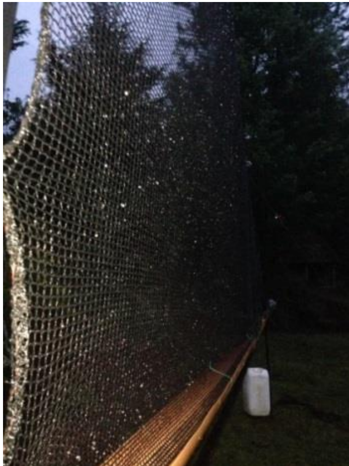
Figura 30. Vista de los colectores en funcionamiento
