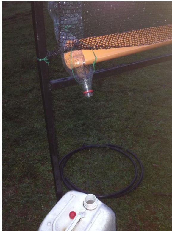
Figura 27. Materiales empleados en la conducción del agua
