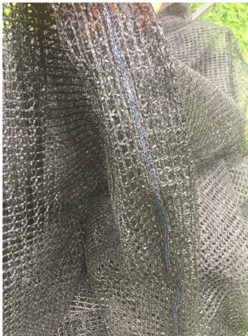
Figura 26. Vista del cosido de malla
