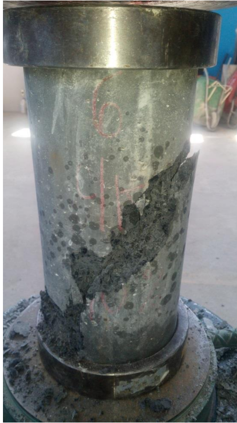
Figura 32. Ensayo a compresión de cilindro de concreto
