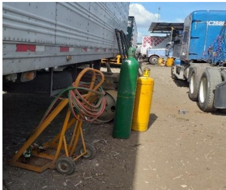
Figura 4. Tanques de oxiacetileno al aire libre
