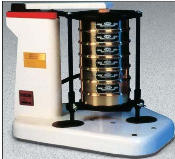
Figura 42. Máquina tamizadora con juego de tamices
