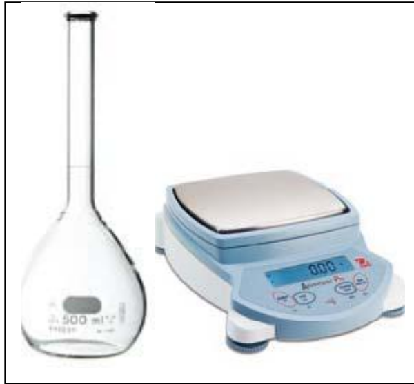
Figura 50. Equipo para determinación de la gravedad específica del suelo
