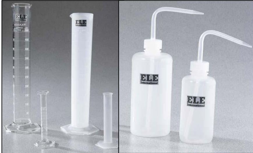
Figura 37. Probeta y pipeta para proveer cantidades controladas de agua
