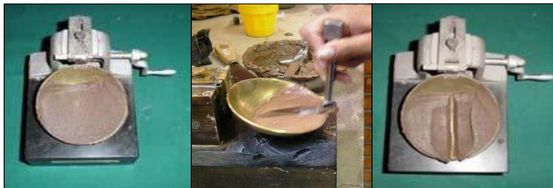
(a) Suelo colocado en la copa
