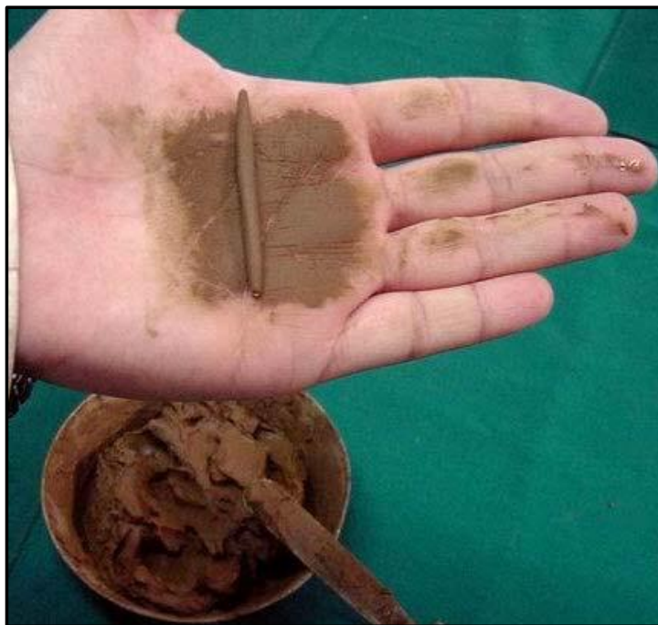
Figura 41. Cilindro de suelo obtenido en el ensayo de límite plástico
