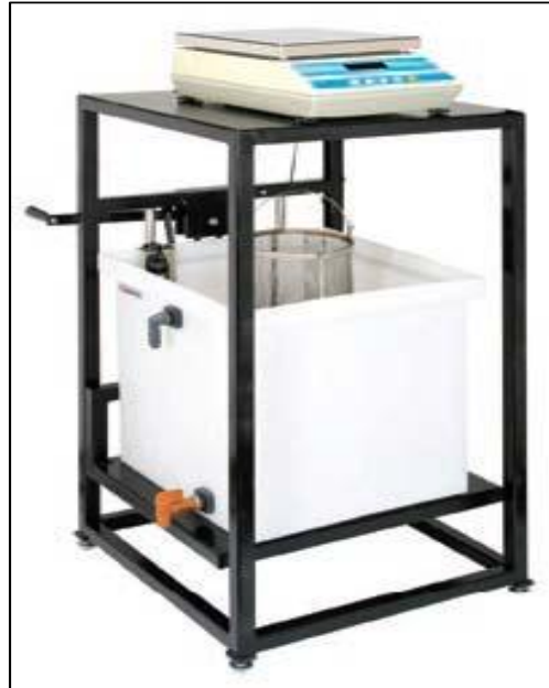
Figura 51. Equipo para determinar el peso específico de una muestra de suelo
