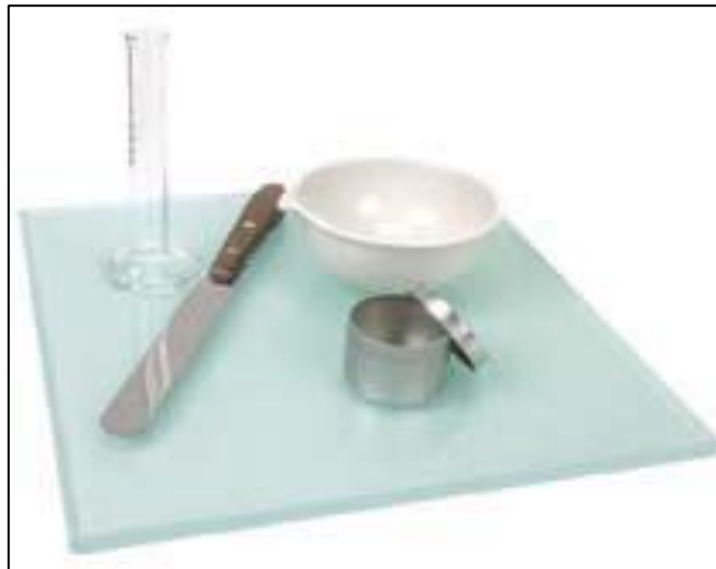
Figura 40. Equipo para determinación de límite plástico
