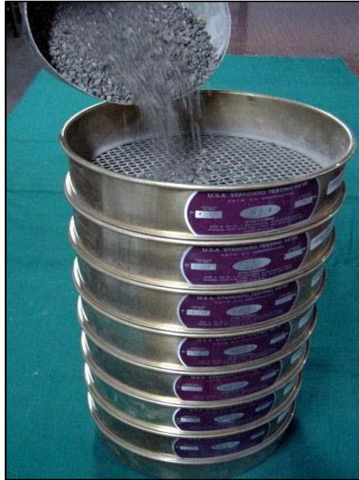
Figura 45. Colocación de una muestra de suelo en el juego de tamices
