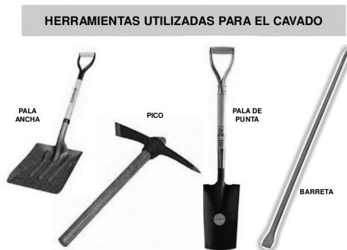
Figura 13. Herramientas utilizadas para excavación manual
