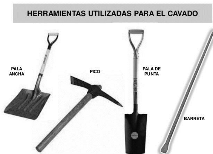
Figura 49. Herramientas utilizadas para excavación manual
