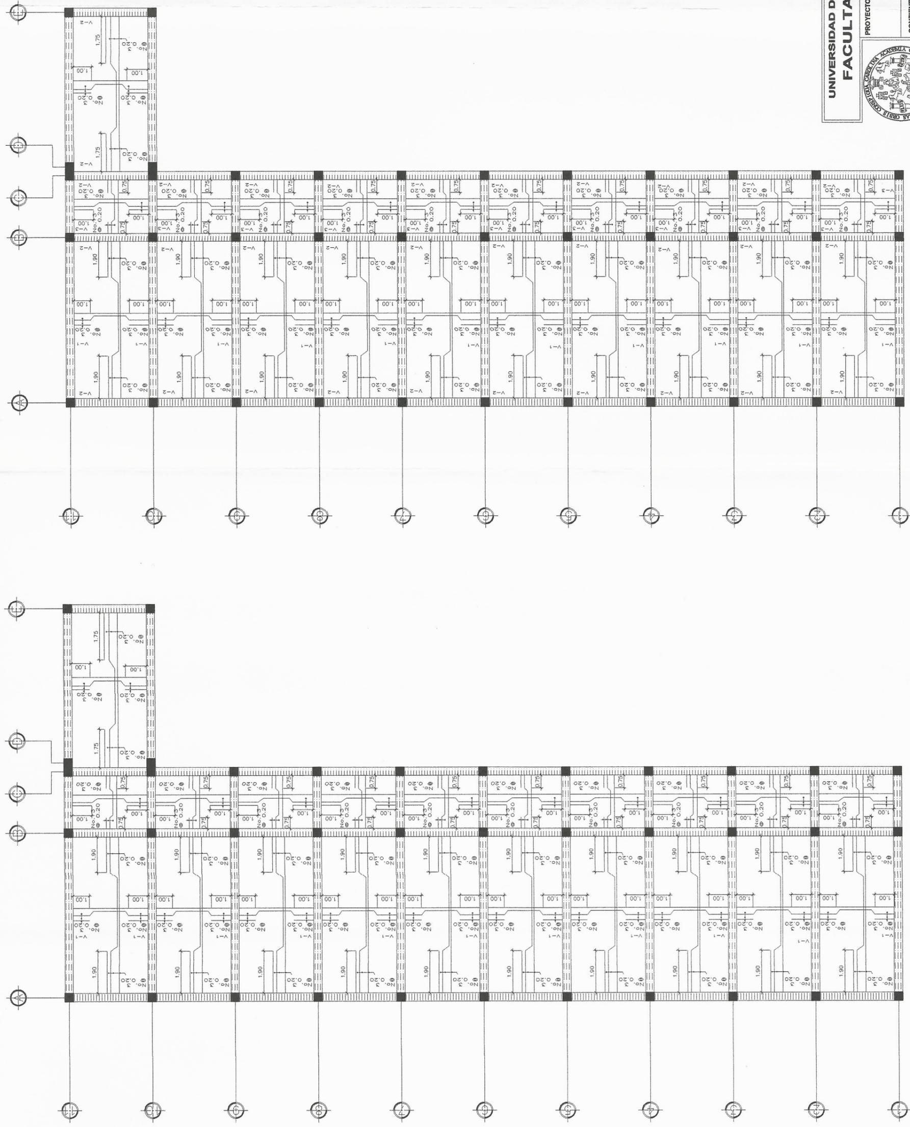
**ARMADO DE LOSA PRIMER NIVEL**
