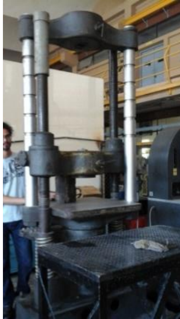
Figura 64. Máquina universal utilizada en el ensayo
