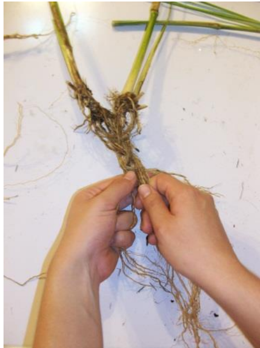
Figura 61. Trenzado de raíces para la formación de una probeta
