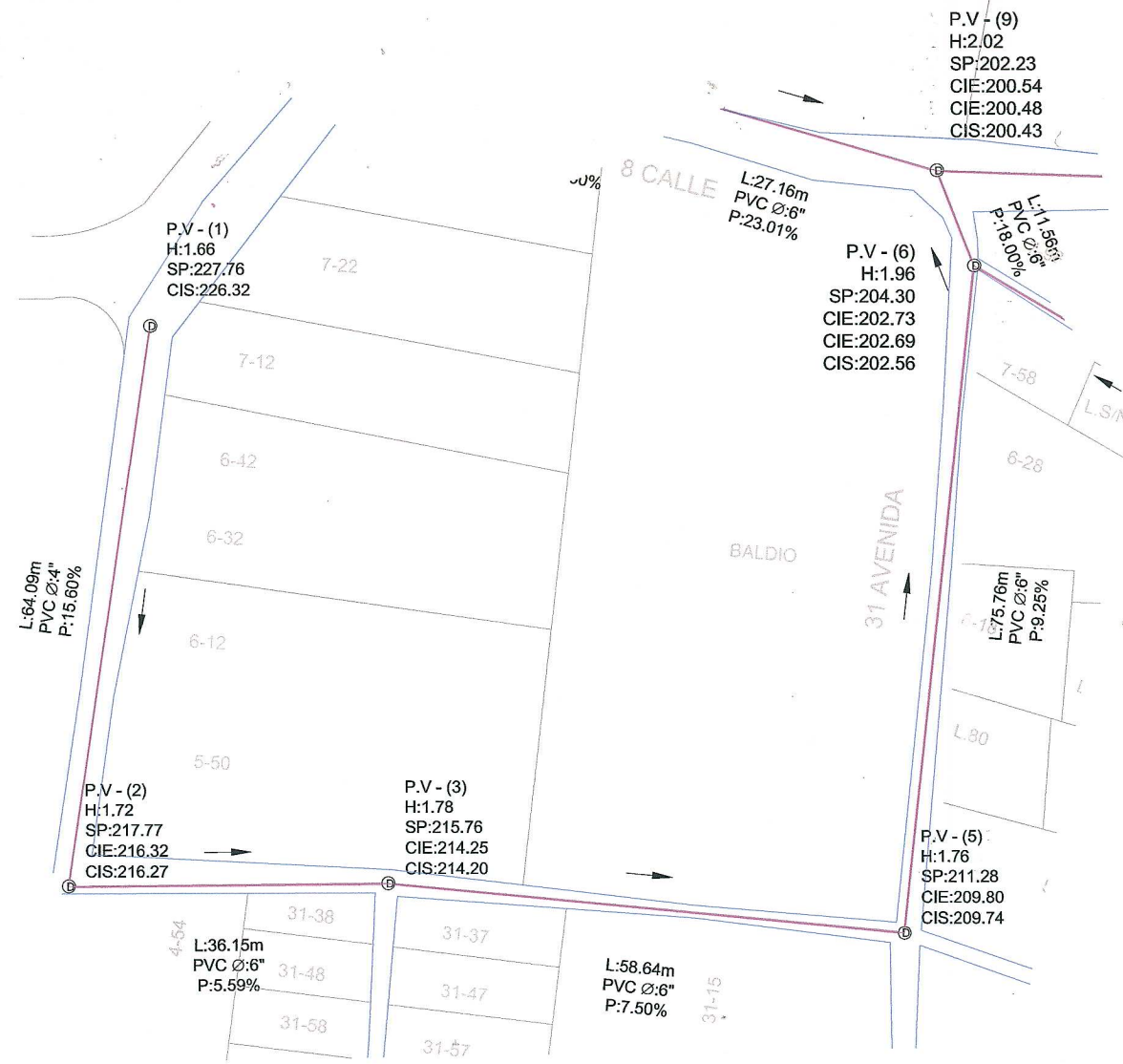
PLANTA DE PV.1 A PV.9
