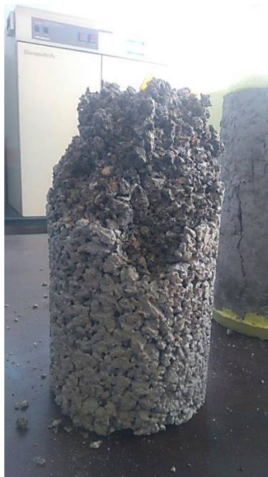
Figura 29. Falla en espécimen de concreto permeable sometido a compresión
