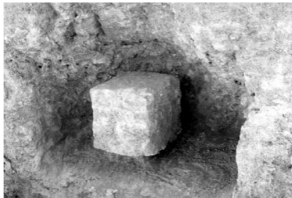
Figura 9. Obtención de una muestra inalterada en un banco de préstamo
