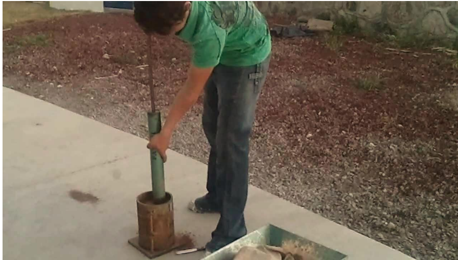
Figura 12. Ensayo Proctor modificado
