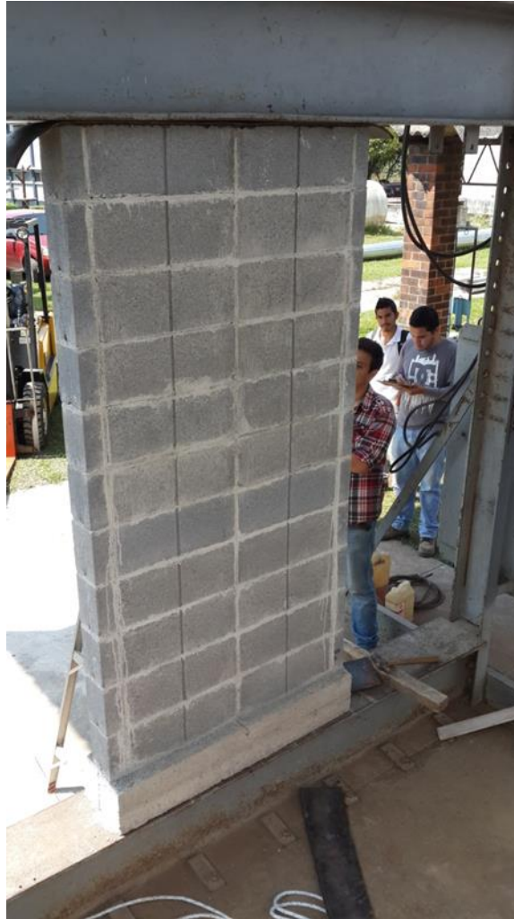
Figura 14. Ensayo del muro a compresión
