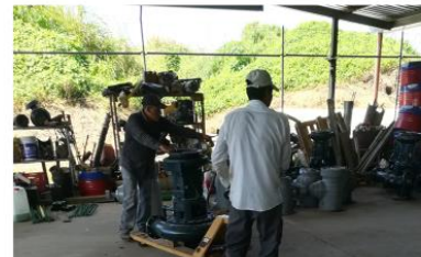
Realización de trabajos sin uso de EPP en Taller La Noria, Escuintla.
