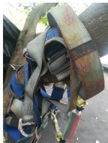
Árnés para trabajo en altura dañado por humedad presente en el lugar de almacenamiento. Equipo de riego El Playón.
