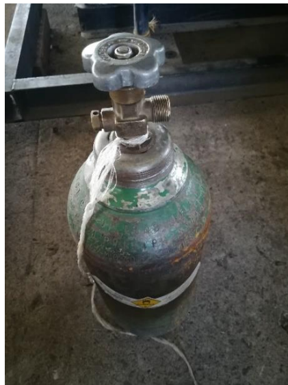
Figura 11. Botella de oxígeno ubicada incorrectamente
