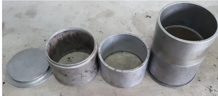
Figura 11. Molde cilíndrico con collar de extensión y placa de base plana para formar las probetas
