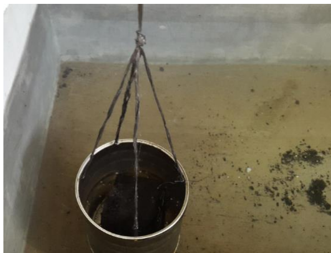
Figura 13. Pileta de agua para la suspensión de probetas
