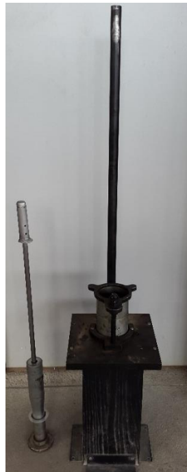
Figura 12. Martillo de compactación de operación manual y pedestal para compactación
