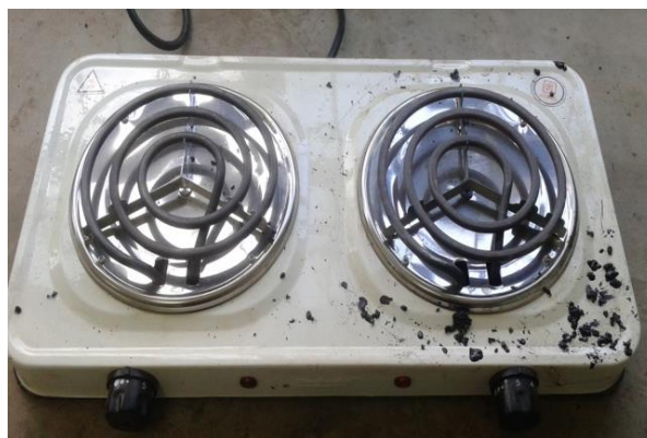
Figura 6. Equipo utilizado para calentar la mezcla asfáltica
