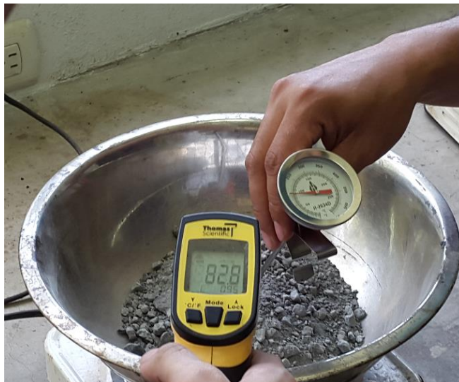
Figura 8. Termómetros adecuados para medir temperatura
