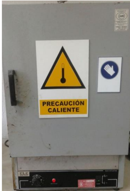
Figura 5. Horno graduado utilizado para calentar los agregados, moldes y el bitumen (cemento asfáltico)
