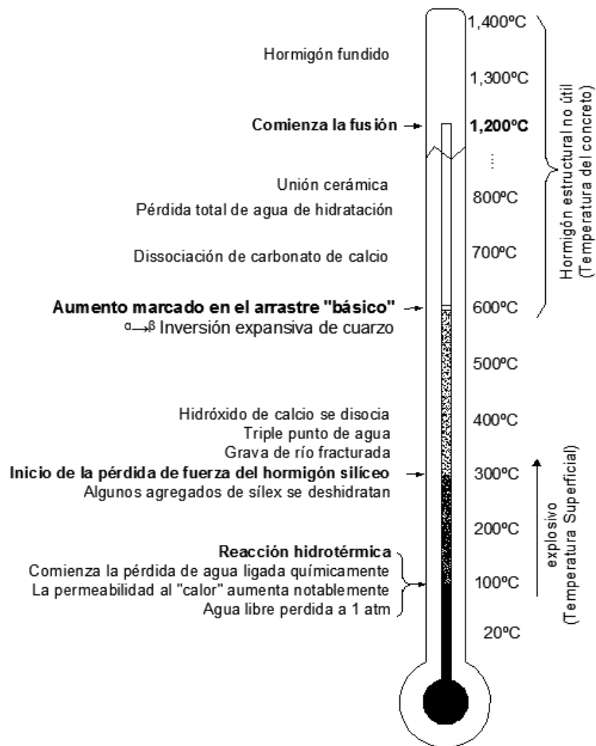
Figura 24. Representación esquemática de los procesos físicoquímicos en el hormigón durante el calentamiento en un termómetro como analogía
