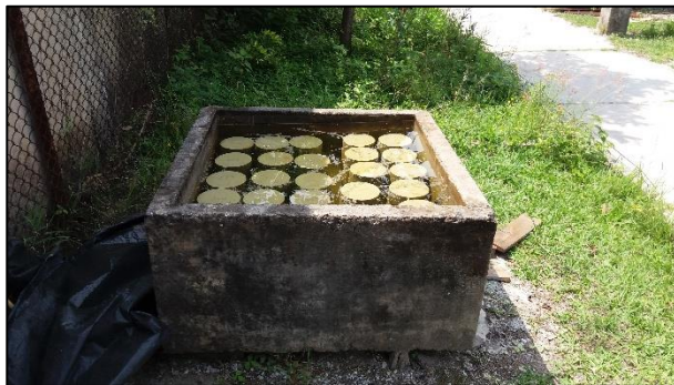
Figura 40. Curado de las muestras cilíndricas
