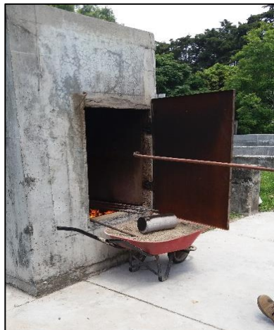
Figura 45. Extracción de los cilindros del horno
