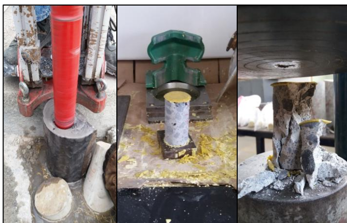
Figura 48. Extracción, nivelación y ensayo de núcleos
