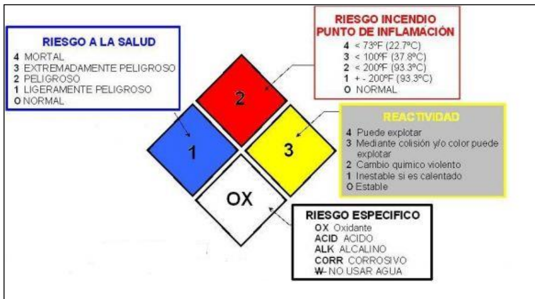
Figura 35. Sistema de identificación de riesgos químicos
