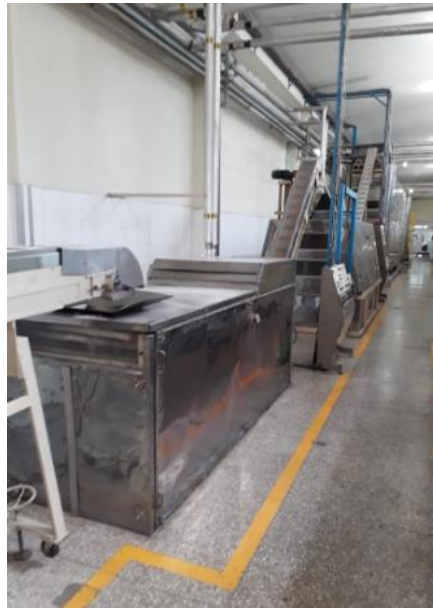
Figura 25. Pasta corta ingresando en el trabato, para luego transportarse al área de secado por medio de un elevador
