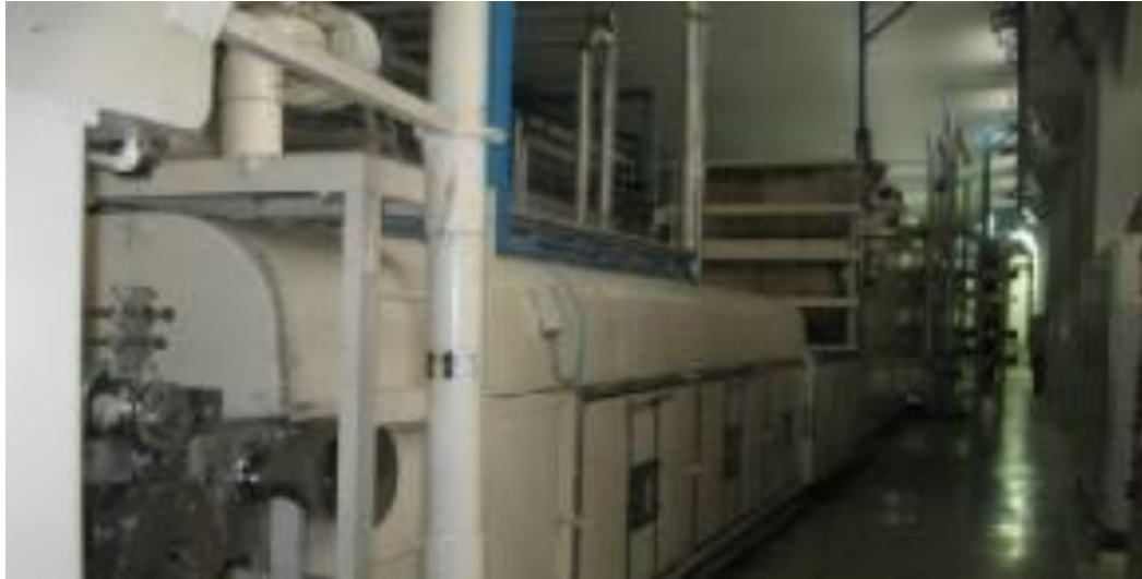
Figura 27. Horno de presecado y niveles de secado para línea de pasta larga
