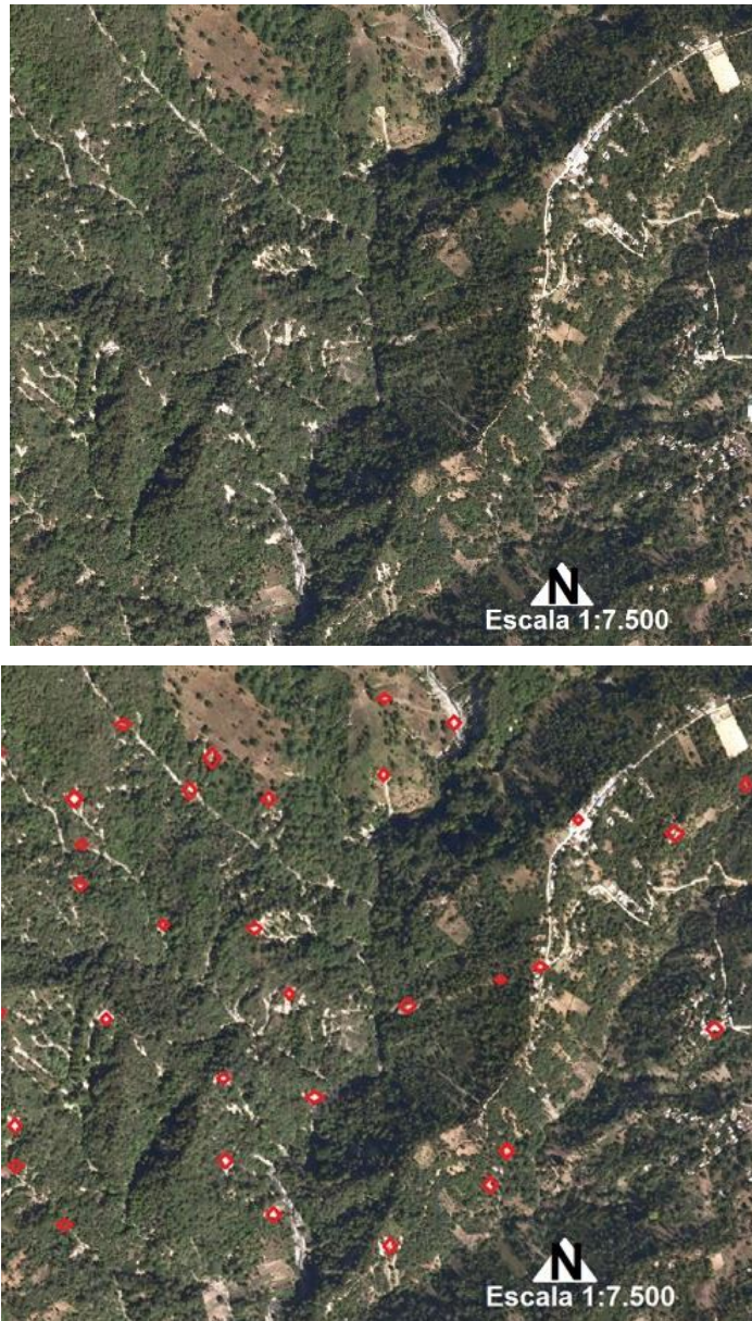
Figura 25. Movimientos de masa que tuvieron lugar durante la tormenta tropical Stan
