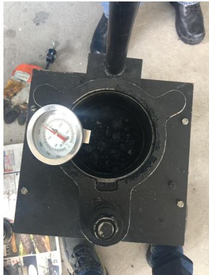
Figura 8. Pedestal de compactación y termómetro para medición de temperatura
