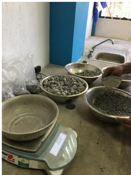
Figura 9. Equipo de medición de material para mezcla asfáltica
