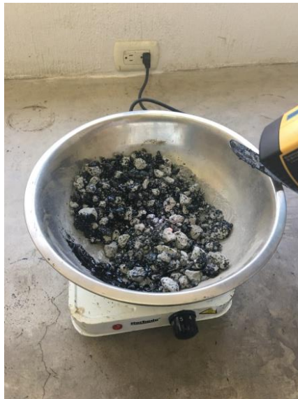
Figura 7. Equipo utilizado para calentar mezcla asfáltica y medición de temperatura
