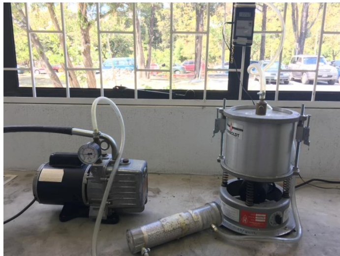
Figura 12. Bomba de vacío, picnómetro para vacío y dispositivo de agitación. Dispositivo para atrapar el vapor de agua y manómetro de presión residual
