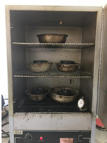
Figura 6. Equipo utilizado para calentar agregados, cemento asfáltico
