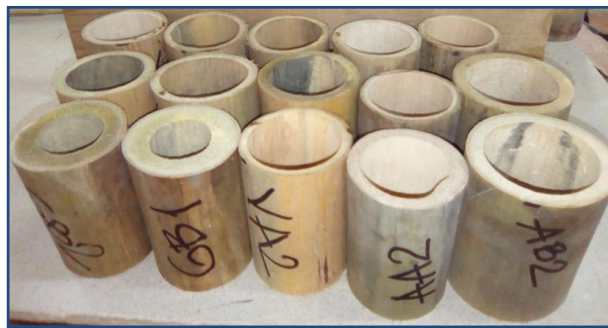
Figura 40. Probetas para el ensayo de resistencia a tensión perpendicular a la fibra
