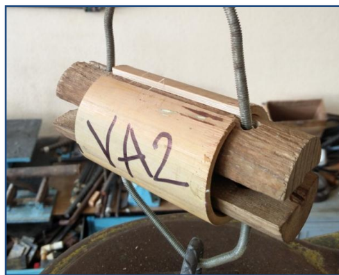
Figura 43. Falla por corte
