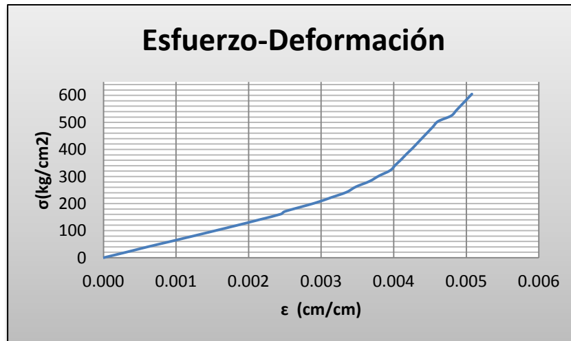
Figura 59. Diagrama de esfuerzo frente a deformación de la especie G. Angustifolia
