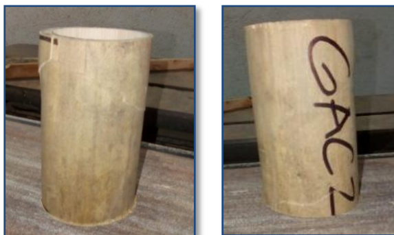
Figura 49. Fallas en las probetas después de la aplicación de carga
