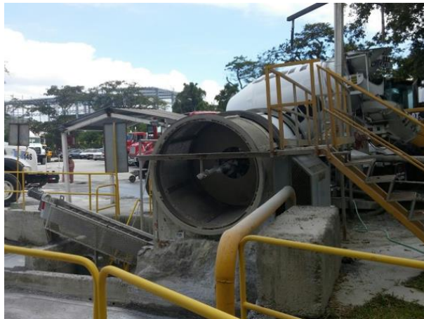
Equipo de reciclamiento de concreto residual en camiones y agua de lavado
