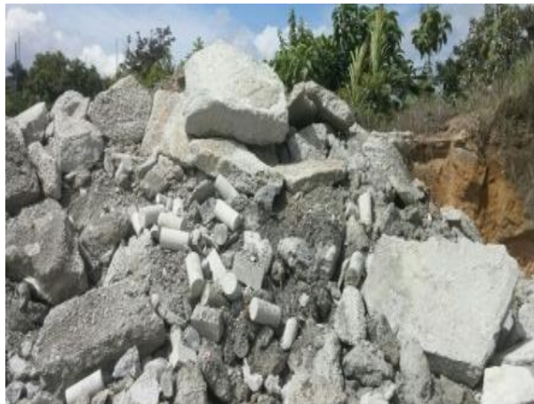
Figura 20. Disposición final de concreto residual en planta 3
