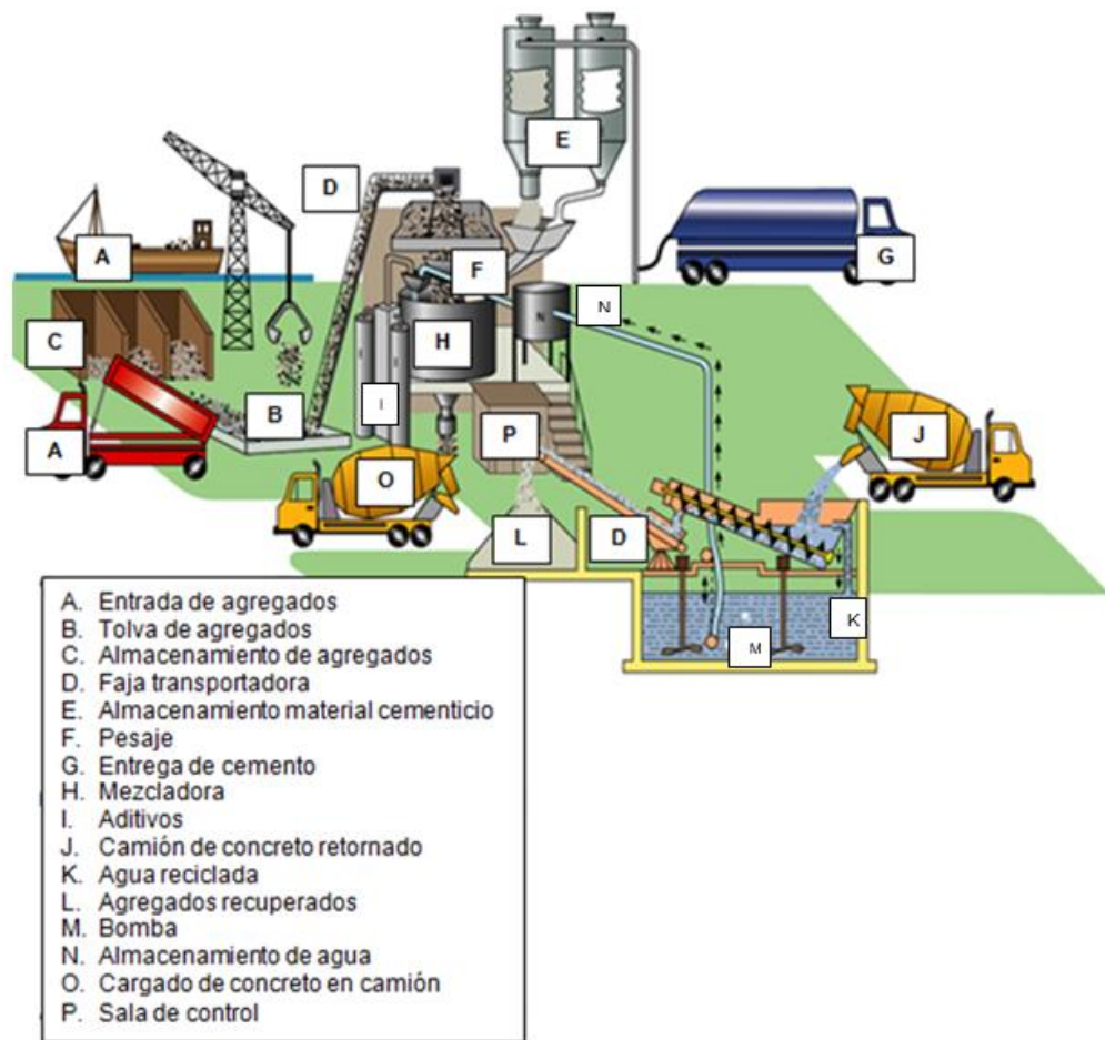
Figura 2. Actividades de producción, planta de concreto premezclado
