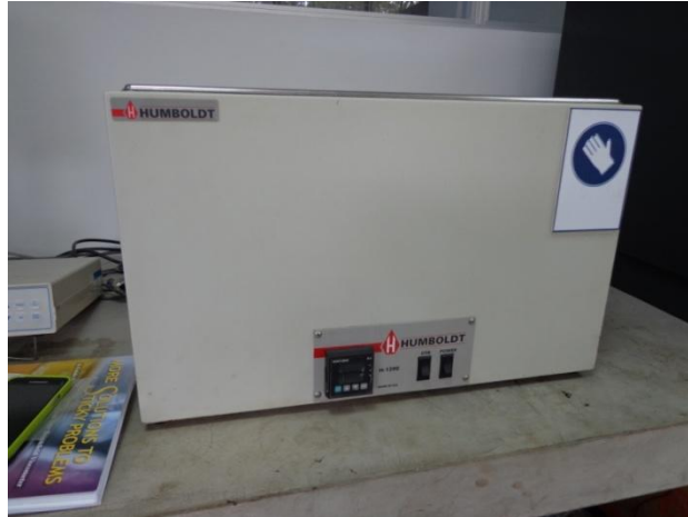
Figura 17. Baño de circulación de agua
