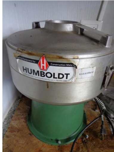
Figura 19. Extractor de la centrifuga de asfaltos
