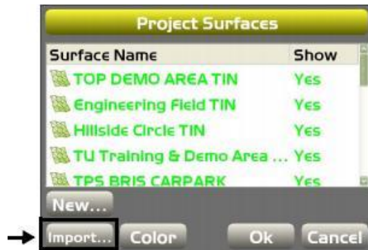
Figura 14. Importar superficie a motoniveladora
