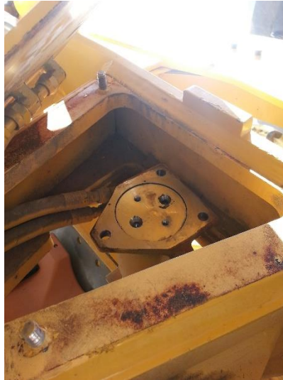
Figura 22. Colocación de sensor de rotación en motoniveladora
