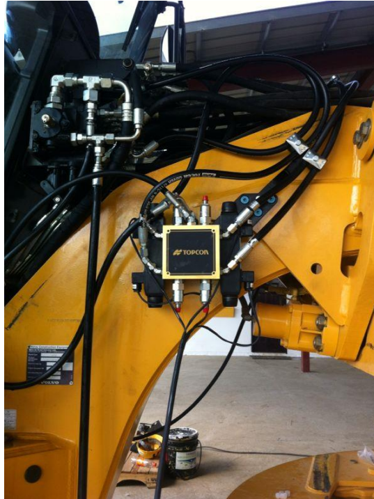
Figura 25. Sistema de válvulas colocado en motoniveladora
