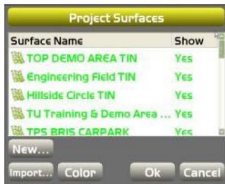
Figura 13. Seleccionar superficie para cargarla al sistema Topcon en motoniveladora
