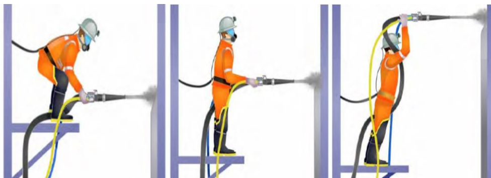
Figura 15. Proceso de aplicación de concreto lanzado
