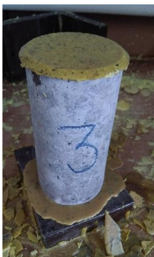
Figura 31. Núcleo cabeceado con azufre
