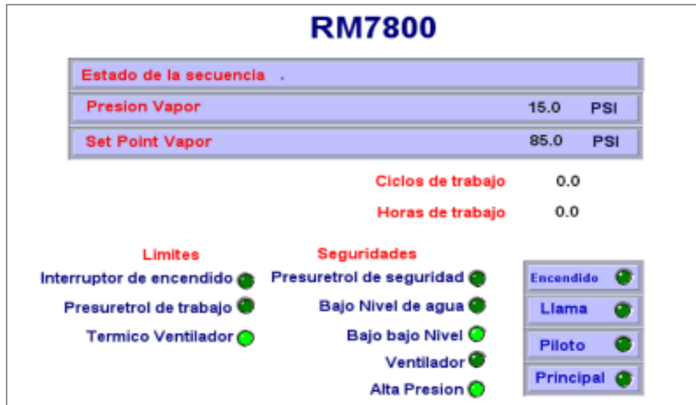
Figura 31. Pantalla RM7800 indica los límites y seguridad
