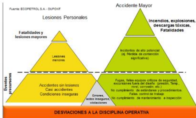
Figura 6. Diagrama consecuencia vs. Probabilidad en PSM y HSE
