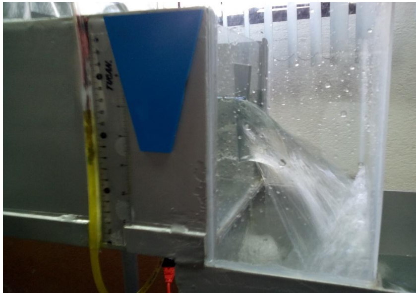
Figura 38. Ensayo del vertedero trapezoidal
