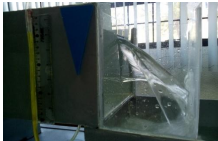
Figura 36. Ensayo del vertedero triangular
