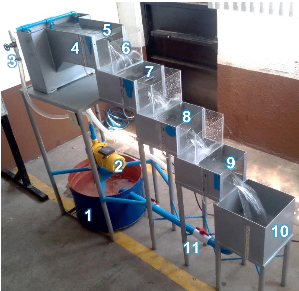
Figura 50. Descripción del equipo simultáneo de medición de caudales
