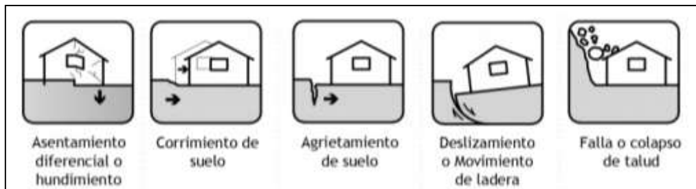
Figura 10. Condiciones de la estructura con relación al terreno
