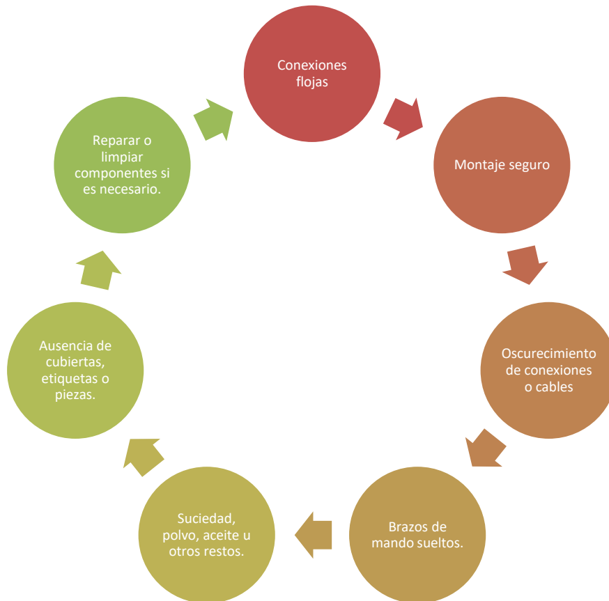
Figura 33. Realizar inspecciones de los componentes eléctricos para detectar las siguientes fallas
