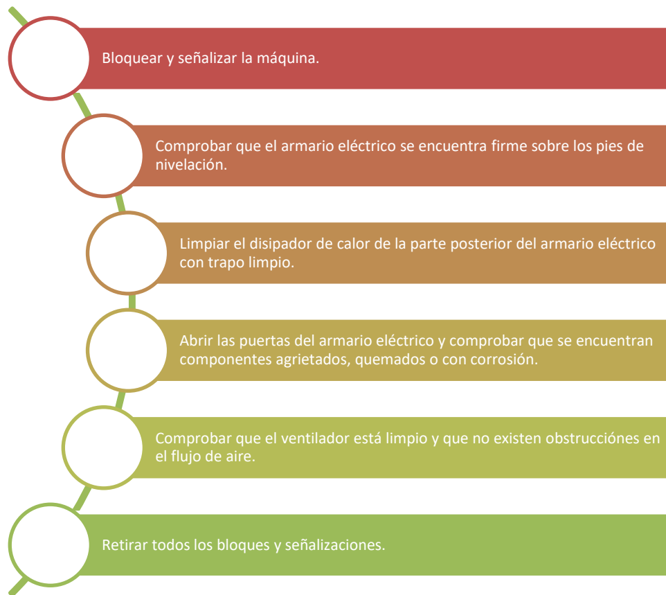
Figura 32. Inspecciones cotidianas que forman parte del mantenimiento del sistema eléctrico
