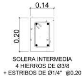
Figura 21. Solera intermedia, humedad
