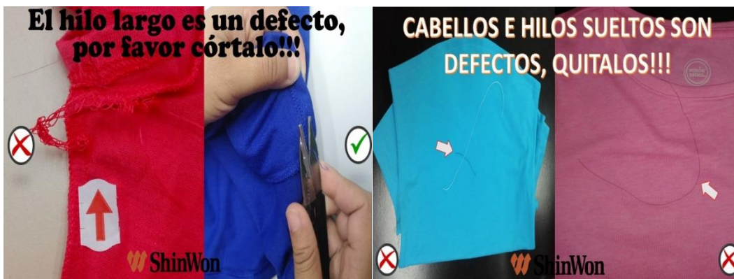
Figura 75. Información gráfica sobre la advertencia de corregir los defectos de hilo suelto en algunas operaciones
