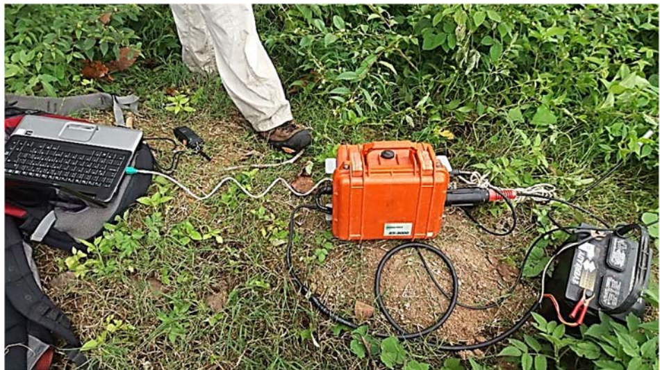
Figura 21. Sismógrafo, batería y computadora
