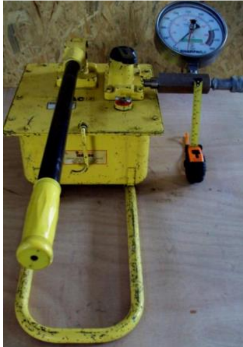
Figura 35. Bomba hidráulica P- 462
