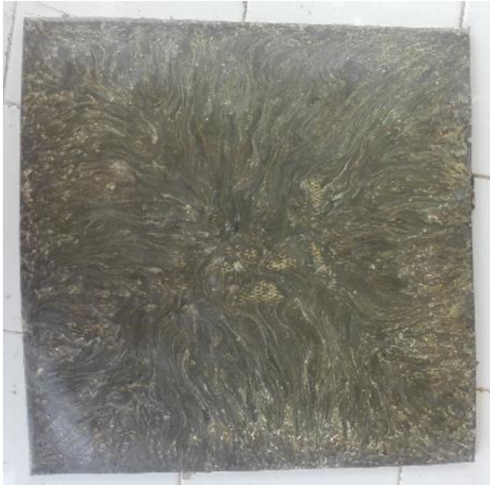
Figura 71. Muestra con exceso de finos
