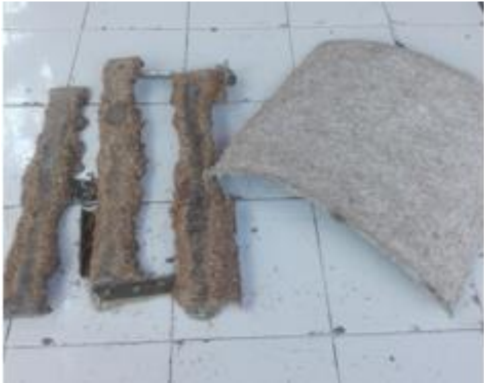
Figura 67. Muestra con exceso de finos
