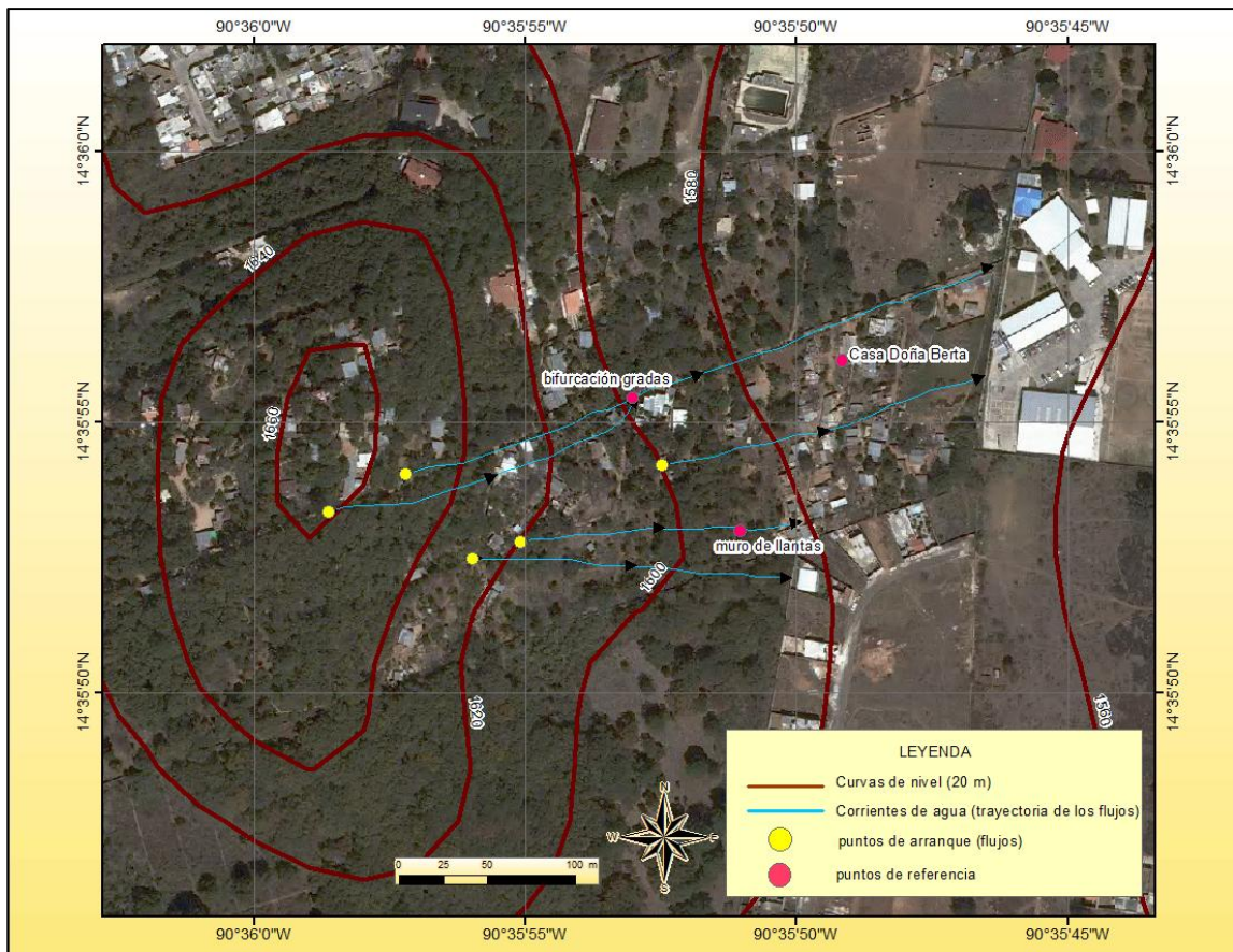
Figura 14. Identificación de zonas de arranque y trayectos de escorrentía superficial
