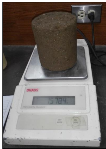
Figura 48. Toma de peso de probeta
