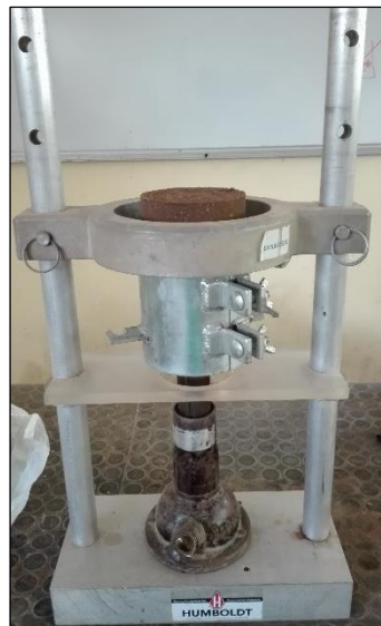
Figura 47. Extracción de probeta de suelo, del molde de compactación
