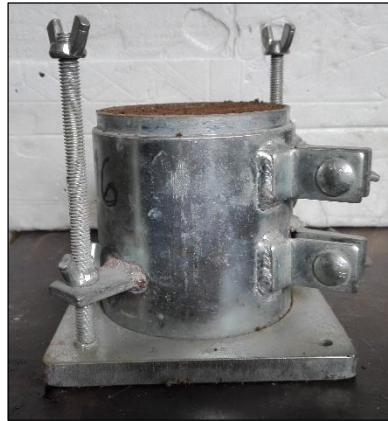
Figura 46. Probeta en el molde de compactación
