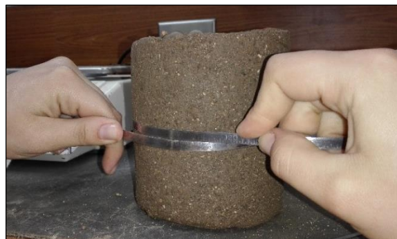
Figura 49. Medición de dimensiones de las probetas
