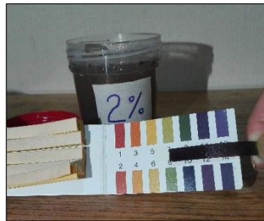
Figura 36. Determinación de pH de muestra de suelo con 2 % de cal
