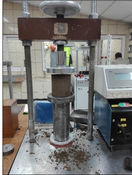
Figura 51. Falla de probeta posterior a ser sometida al ensayo de compresión
