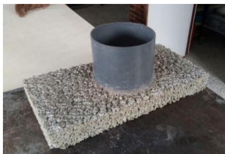
Figura 22. Placa para prueba de infiltración
