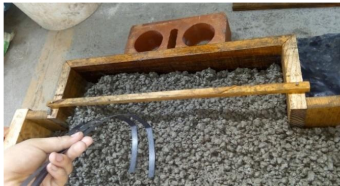
Figura 11. Instalación de flejes
