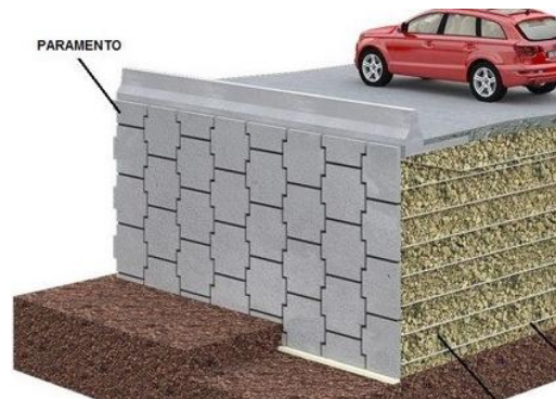
Figura 6. Fachada de muros de paramento
