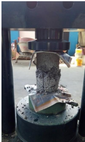
Figura 20. Aplicación de carga a compresión
