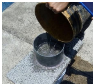
Figura 23. Ensayo de permeabilidad
