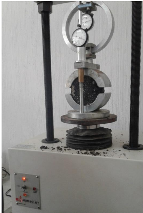
Figura 13. Anillo dinamométrico, deformímetro de lectura fija. Dispositivo de compresión para rotura de probetas
