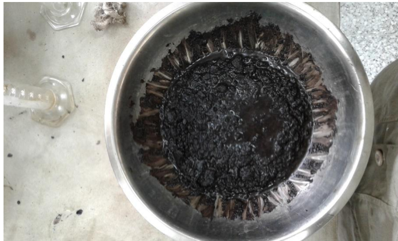
Figura 17. Preparación de la emulsión asfáltica
