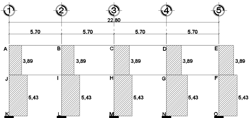
Figura 31. Diagrama de cortantes últimos (ton) para columnas, marco X
