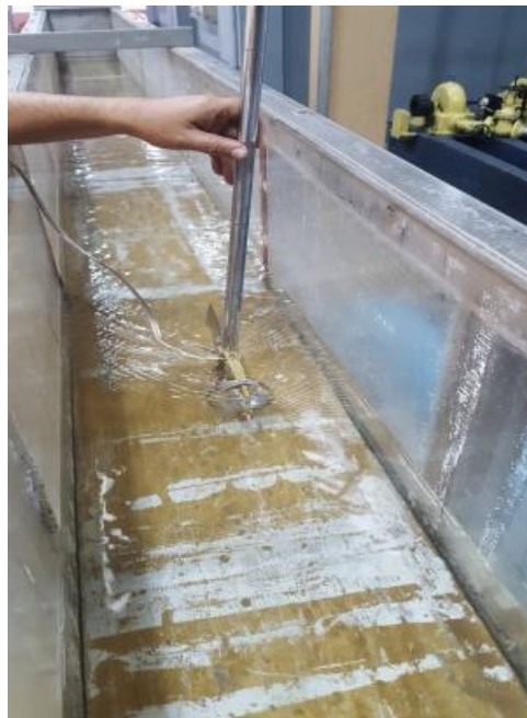
Figura 20. Aforo con molinete, en Laboratorio de Hidráulica de la Facultad de Ingeniería de la Universidad de San Carlos de Guatemala
