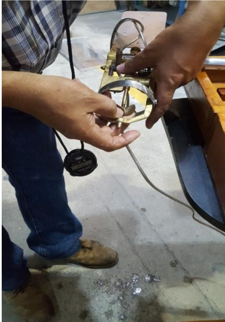
Figura 44. Instalación de hélices del molinete
