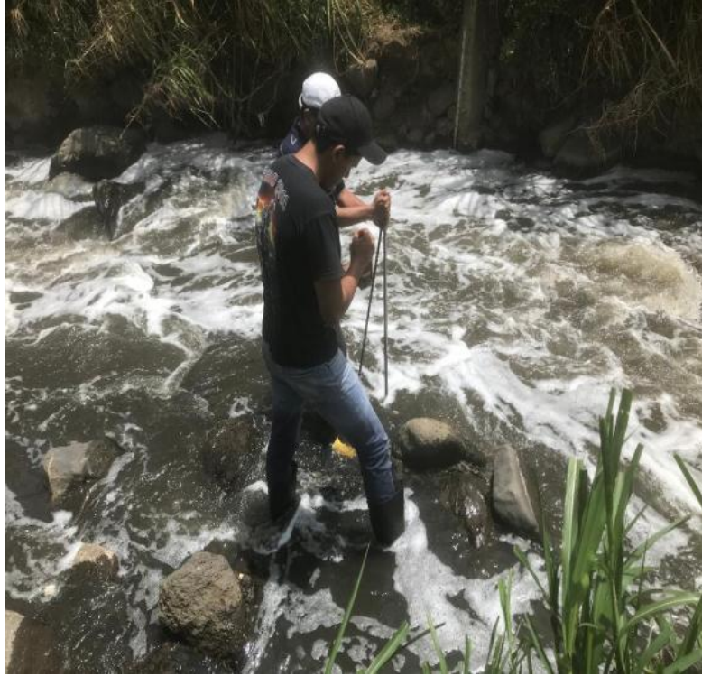
Figura 58. Método por vadeo en Alotenango II
