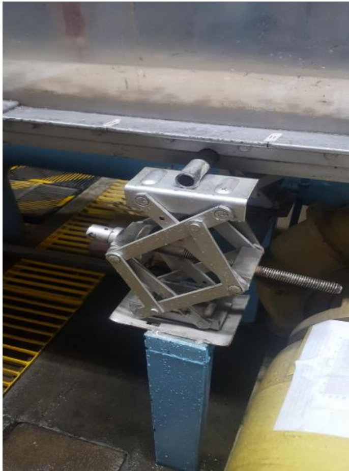
Figura 37. Sistema para elevación de la pendiente en el canal
