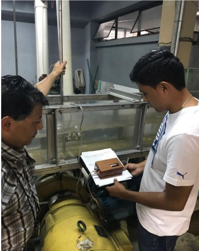
Figura 30. Contador de revoluciones de las hélices / a la izquierda Ing. Alan Cosillo y a la derecha Didier Fernández
